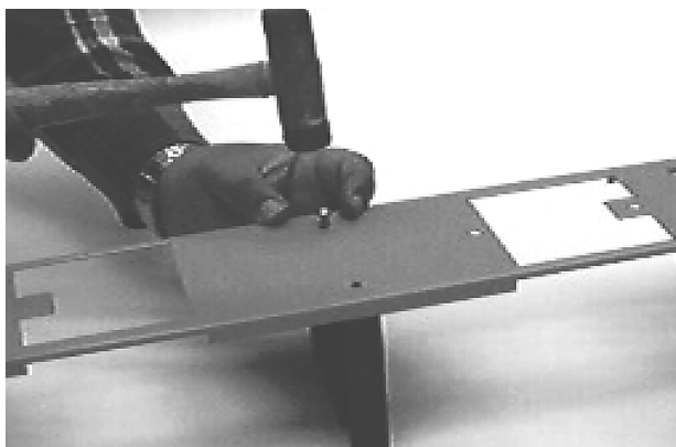
Figure 2. Fixation de la barrière du centre au couvercle de disjoncteur.
