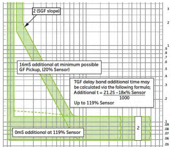
**GROUND FAULT CT PICKUP (ENTELOGUARD G ONLY)**
